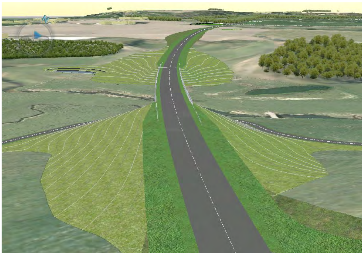
Figur 4.6. Terræntilpasning på ådalens nordside, set fra syd.
