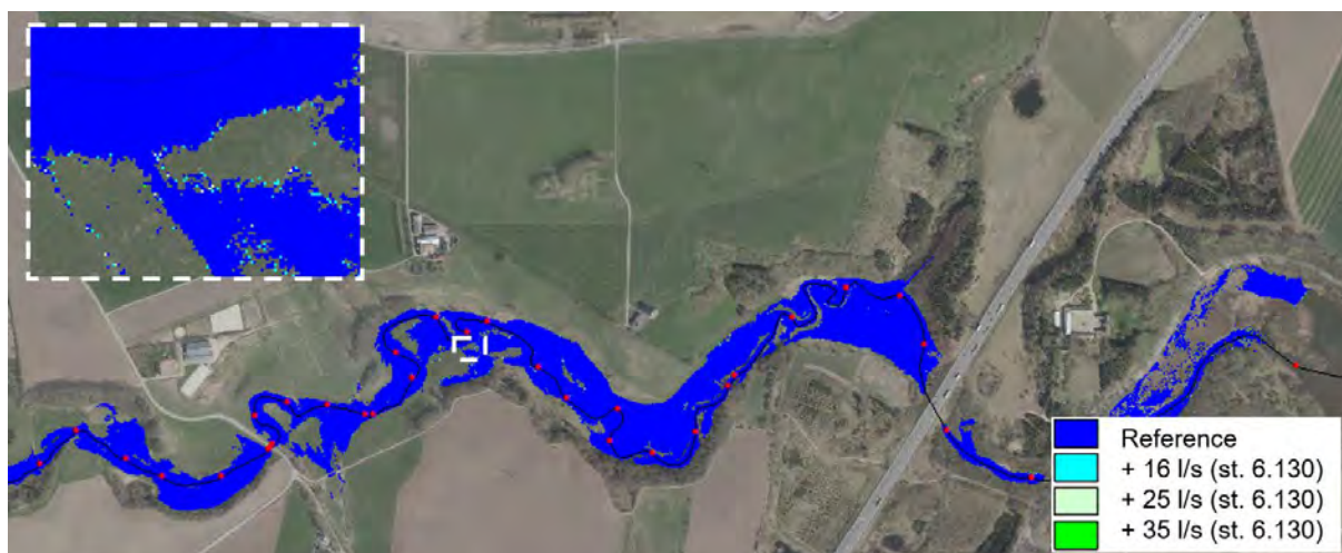
Figur 9 Beregnet oversvømmelsesudbredelse i scenarierne: reference (medianmaksimumafstrømning), medianmaksimumafstrømning + 16 l/s, medianmaksimumafstrømning + 25 l/s og medianmaksimumafstrømning + 35 l/s. Der ses kun en minimal og ubetydelig ændring som følge af udledningen fra vejprojektet. Der er anvendt et Manningtal på 13 i beregningerne.
