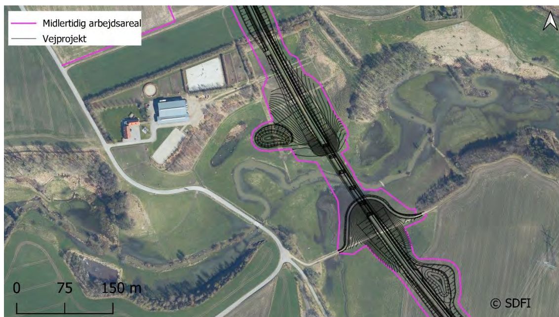
Figur 13.4: Der etableres midlertidige arbejdsarealer omkring det nye vejprojekt.
