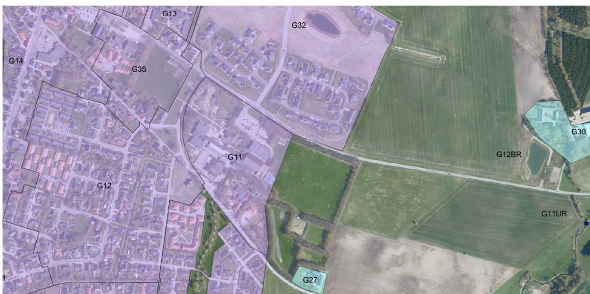
Figur 2. oversigtskort der viser placering af de separatkloakerede oplande G11, G12 og G35 samt placering af bassin G12BR og udløb G11UR (markeret med blå stjerne)
